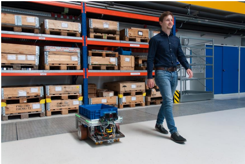
Abb. 1: Der Transportroboter »FOLLOWme ILS« erkennt Personen und kann ihnen flexibel und sicher folgen (Copyright: TU Chemnitz)
