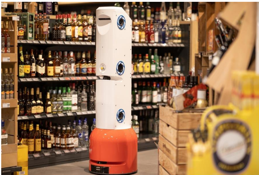
Abb. 2: Der Roboter »ROTAROR« erkennt Lücken im Warenbestand und meldet sie an das Personal – so werden Umsatzeinbußen verhindert (Copyright: metralabs GmbH)
